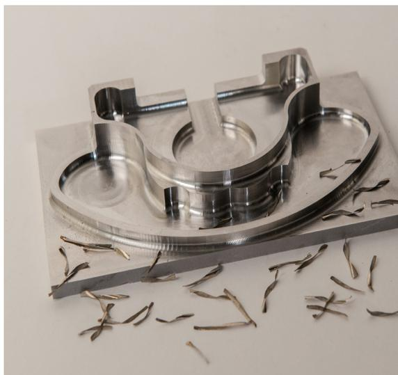
Importer un STEP de votre client, puis en quelques minutes, placez votre gamme d'usinage préférée pour réaliser l'ébauche, la reprise, les perçages puis les taraudages, les chanfreins et les passes de finitions..
